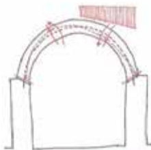
ROTURA POR GARGANTA EXTERIOR Y DEFORMACIONES ASIMÉTRICAS
