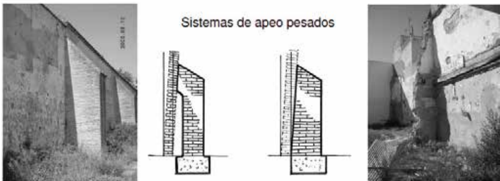
Figura 8.8. Sistemas de apeos pesados. Ricardo Huete Fuertes. Dr. Arquitecto
