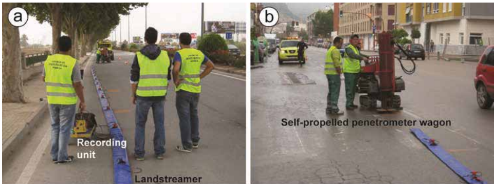
Figura 1.49. Sistema de registro sísmico por las calles de Lorca (a). Equipo penetrométrico utilizado como fuente sísmica (b) (Martínez-Pagán et al., 2012).
