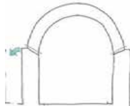
ROTURA POR GIRO EXTERIOR
