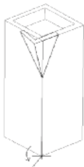
Figuras 4.86 y 4.87 44 : Esquema de expulsión de esquina e imagen de la torre del Espolón. Lorca.
