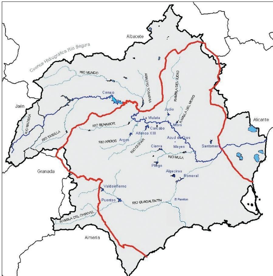
En caso de avenida, el azud de Ojós, con el fin de aliviar el caudal del cauce principal y reducir la onda de crecida, puede derivar agua aprovechando los canales del postrasvase Tajo-Segura, con una capacidad de 30 m<sup>3</sup>/sg. cada uno. Por la margen izquierda deriva hacia el embalse de la Pedrera, y por la margen derecha hacia el embalse del Mayés.
